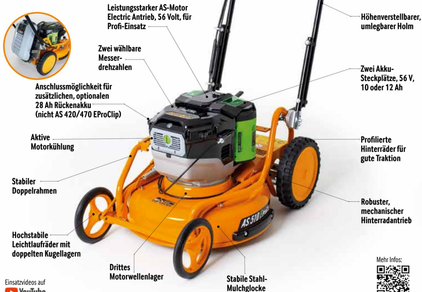
Leistungsstarker AS-Motor Electric Antrieb, 56 Volt, für Profi-Einsatz
