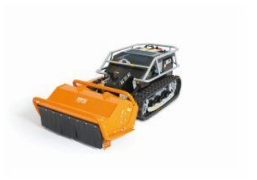
Bild 2: Durch die ferngesteuerte Mähraupe AS 751 RC lässt sich der Riesenbärenklau aus sicherer Entfernung bekämpfen
