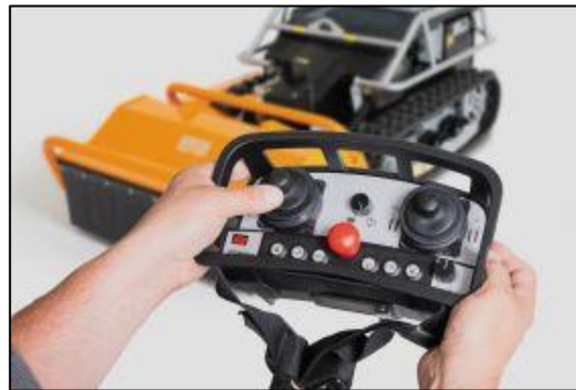
Bild 4: Die Profi-Fernbedienung des AS 751 RC ermöglicht bis zu 300 Meter Abstand zu der Pflanze
